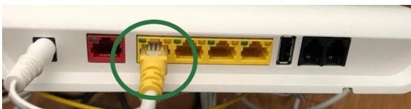
Abb. 9: Port 1 an der Genexis Platinum 7840
